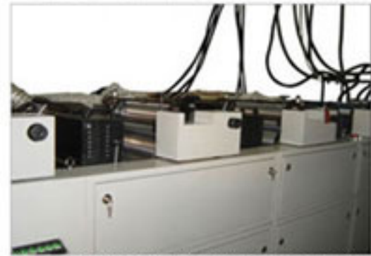
商业表格印刷机配套实例 (刮刮卡银浆 UV 固化)
